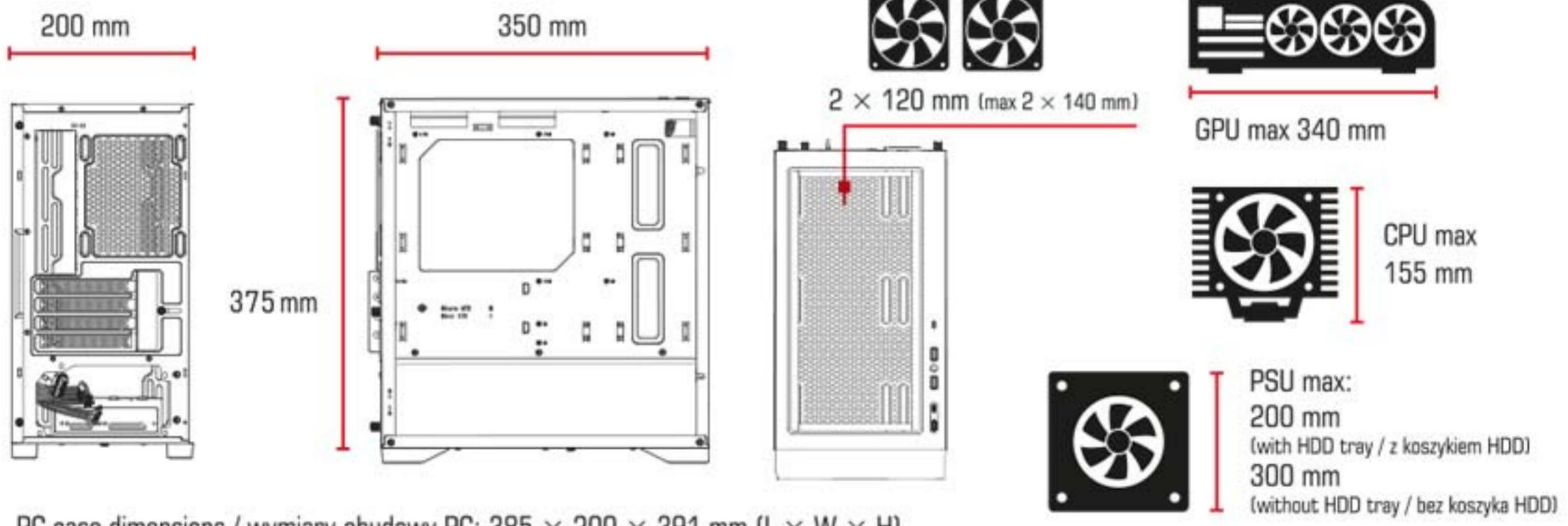
PC case dimensions / wymiary obudowy PC: 385 × 200 × 391 mm (L × W × H)
