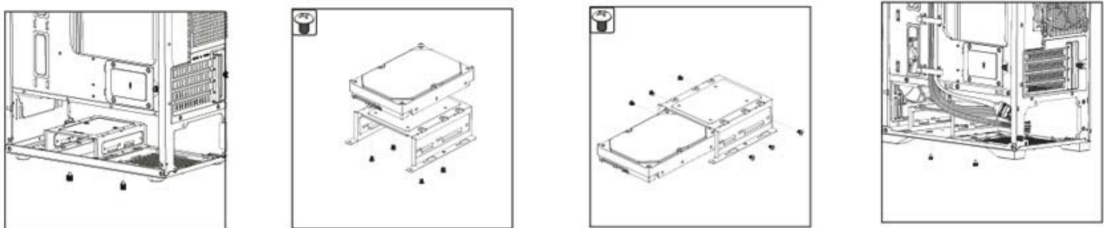
Installing 2.5" SSDs / Montaż dysków 2.5" SSD
