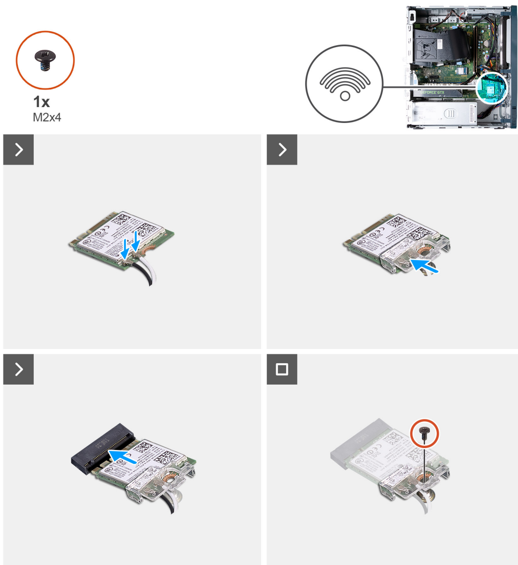
Rysunek 21. Instalowanie karty sieci bezprzewodowej
